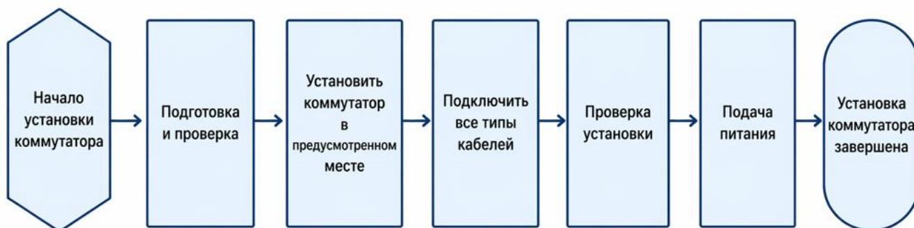
Рисунок 7-1 Блок-схема процесса установки
