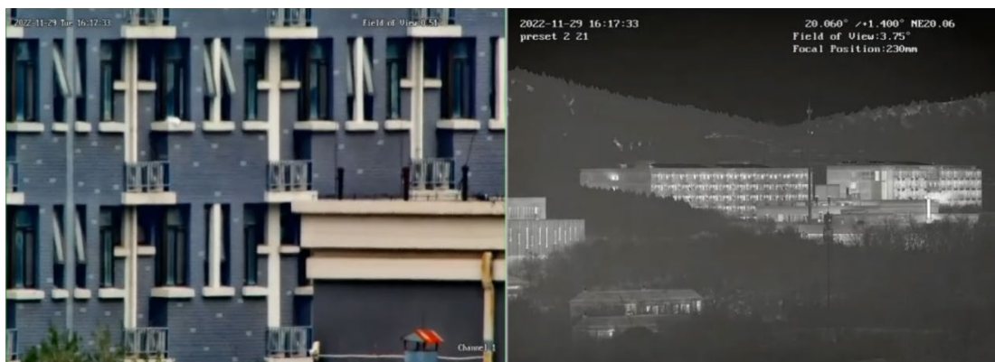
Объектив 230-мм и 100х кратный zoom оптической камеры + тепловизора только с одним IP
